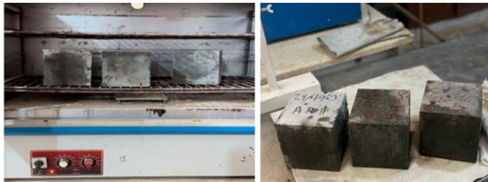
الشكل (8) يوضح الفرن المستخدم في اختبار نسبة امتصاص
