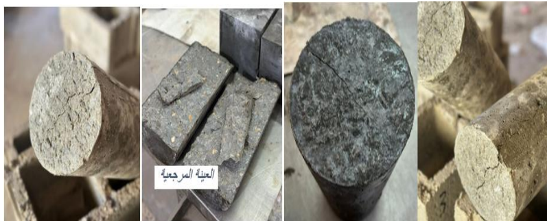
الشكل (14) تأثير إضافة ألياف الكربون على شكل الإنفلاق
