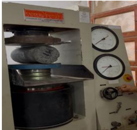
الشكل (10) يوضح اختبار مقاومة الشد الغير مباشر للعينة الإسطوانية
